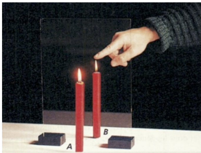
Figure 3.1 – Deux bougies de part et d'autre d'une plaque de verre semi-réfléchissante.
