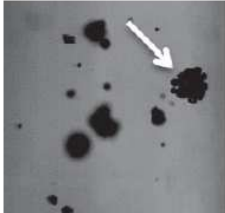
Fig. 5. Fragmentation d'une bulle lors de la propagation d'une onde de choc de forte amplitude dans un mélange eau-bulles d'air, d'après (Ando et al., 2011b). A l'endroit indiqué par la flèche blanche, une bulle vient de fissionner donnant naissance à un amas de bulles de plus petites tailles.
