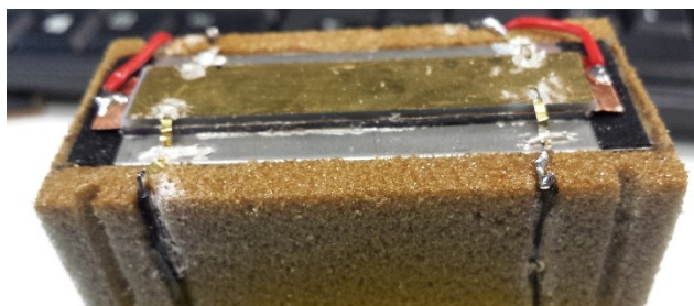
Figure 6: Sonde prototype constituée d'une double couche inversée de PVDF. Surface de réception de 10\text{ mm} \times 40\text{ mm}
