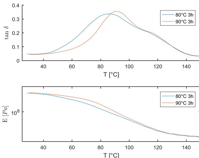
Figure 3: Comparaison de deux cycles de post-cuisson par DMA (10 Hz,  $5\mu\text{m}$ ) et une rampe en température ( $3^\circ\text{C}/\text{min}$ )
