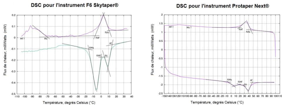
Fig 1. Courbes de DSC des instruments F6Skytaper® et ProTaper Next®
