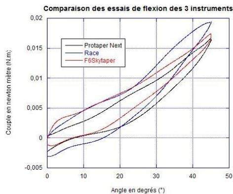
Fig 2. Comparaison des courbes de flexion des 3 instruments
