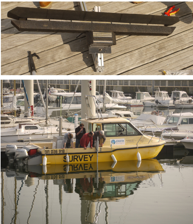
Figure 7: (en haut) photo des antennes (en bas) photo de la vedette "Panopée" et du sonar monté sur le côté (perche).
