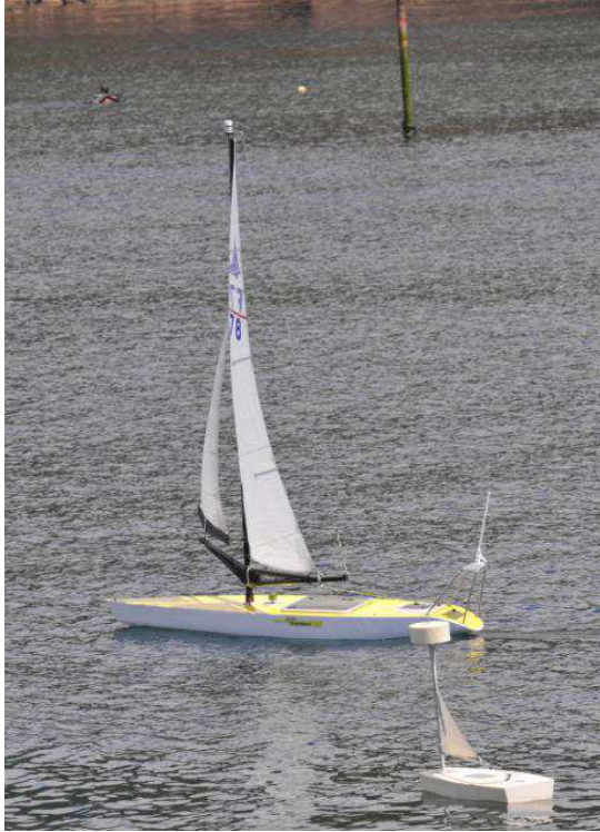
Fig. 1. En arrière plan le robot voilier Vaimos de l'IFREMER et au premier plan le robot Optimousse de l'ENSTA-Bretagne. Auteur : © IFREMER Patrick Rousseaux
