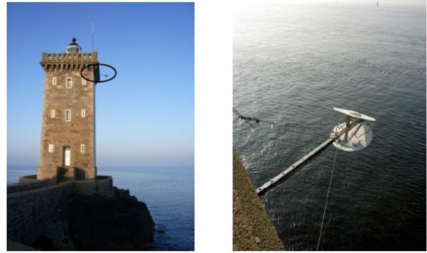
Figure 3. Emplacement des antennes Oceanpal à proximité de la surface maritime : collaboration entre Ifremer & Starlab [3].
