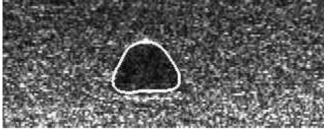
figure 13 : Résultat sur image réelle (ombre portée d'une mine Manta)
